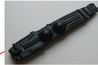
Blasteil : Die Ventilschwimmer werden ausgestanzt
