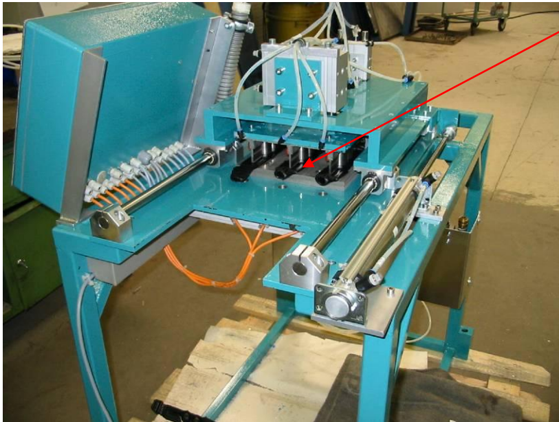
Blasteil : Die Ventilschwimmer werden ausgestanzt
